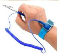
Para no dañar algunos componentes como la tarjeta madre o la memoria RAM, es necesario descargar la electricidad estática que pueda tener nuestro cuerpo. Para ello existen **pulseras** hechas de cinta conductora y conectadas con un cable fino de aproximadamente 70 – 80 cm con una pinza que se coloca a tierra o al chasis de la PC., y que recomendable tener puestas mientras se tocan los equipos.
