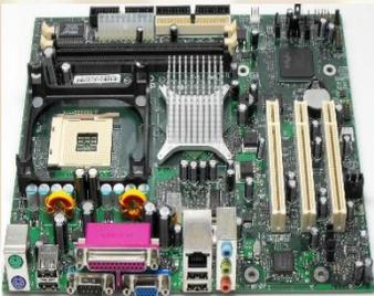
**Tarjeta Madre:** o también conocida como la placa de sistema o placa principal es la médula de la computadora es una placa de circuito impreso (PCB) que contiene los buses o rutas eléctricas para la interconexión de los componentes electrónicos de una computadora. Existen tres formas comunes de placa madre:
